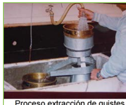
Proceso extracción de quistes
