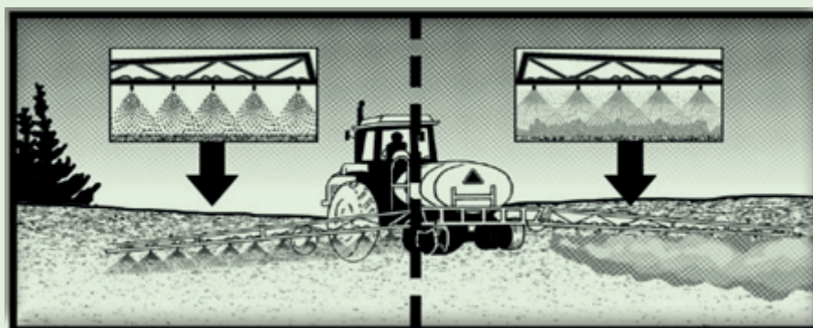
Figura 6-4: El tamaño de la gota de agua juega un papel importante en la deriva de la pulverización.
